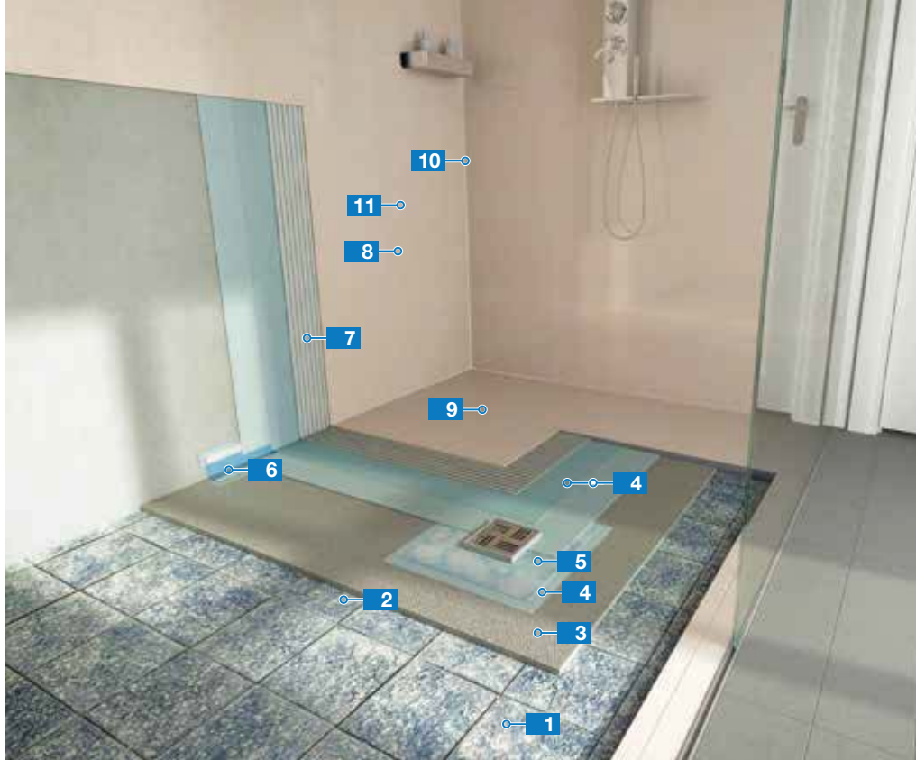
Fürdőszobák felújítása vízszigetelő rendszerrel és üvegmozaik burkolással
